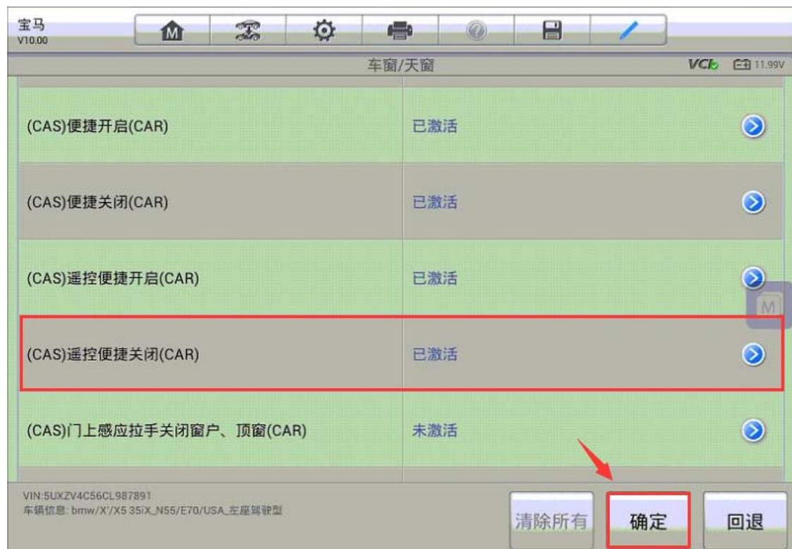
6. 点击“确定”对相应的模块进行编码，编码完成后，可以看到已激活成功的提示；使用遥控器可以正常关闭车窗，功能完成。
