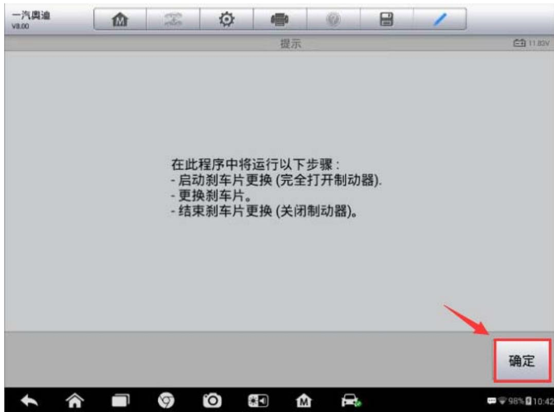
5. 执行步骤“1-启动制动片更换（完全打开制动器）”
