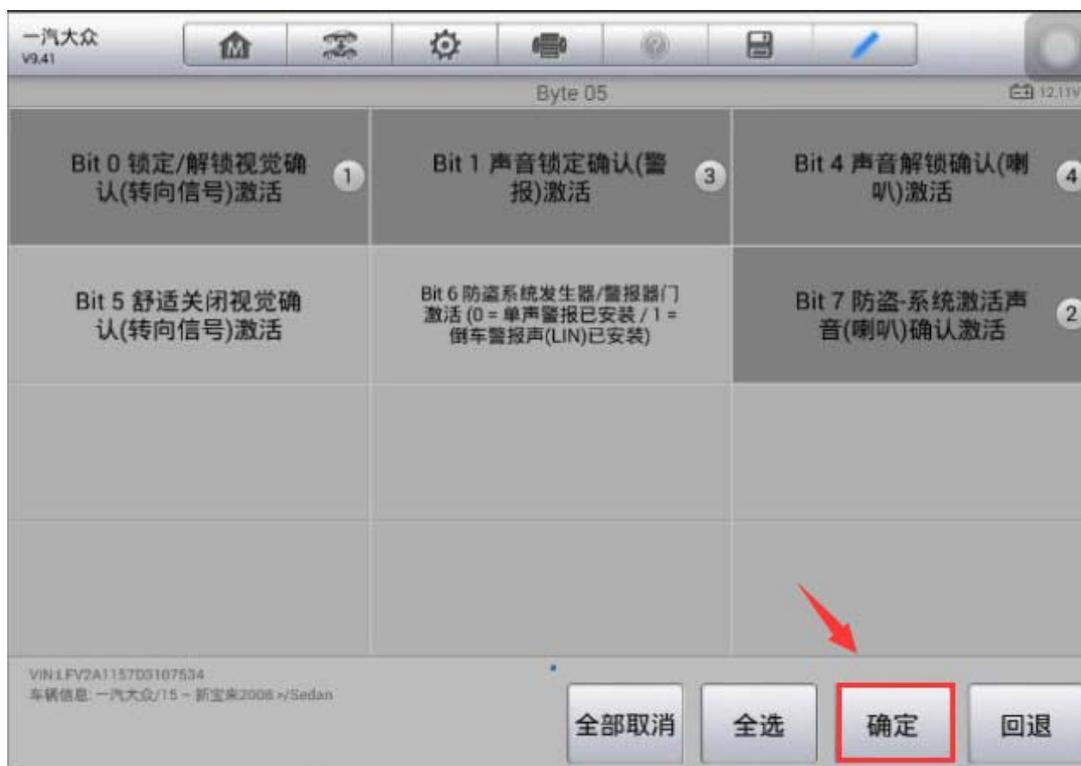
10. 在长编码界面，此时，在“字节 05”我们可以看到“Bit 1 声音锁定确认（警报）激活”与“Bit 4 声音解锁确认（喇叭）激活”选项前面的状态为“√”，表明此功能已被激活，点击“确定”；
