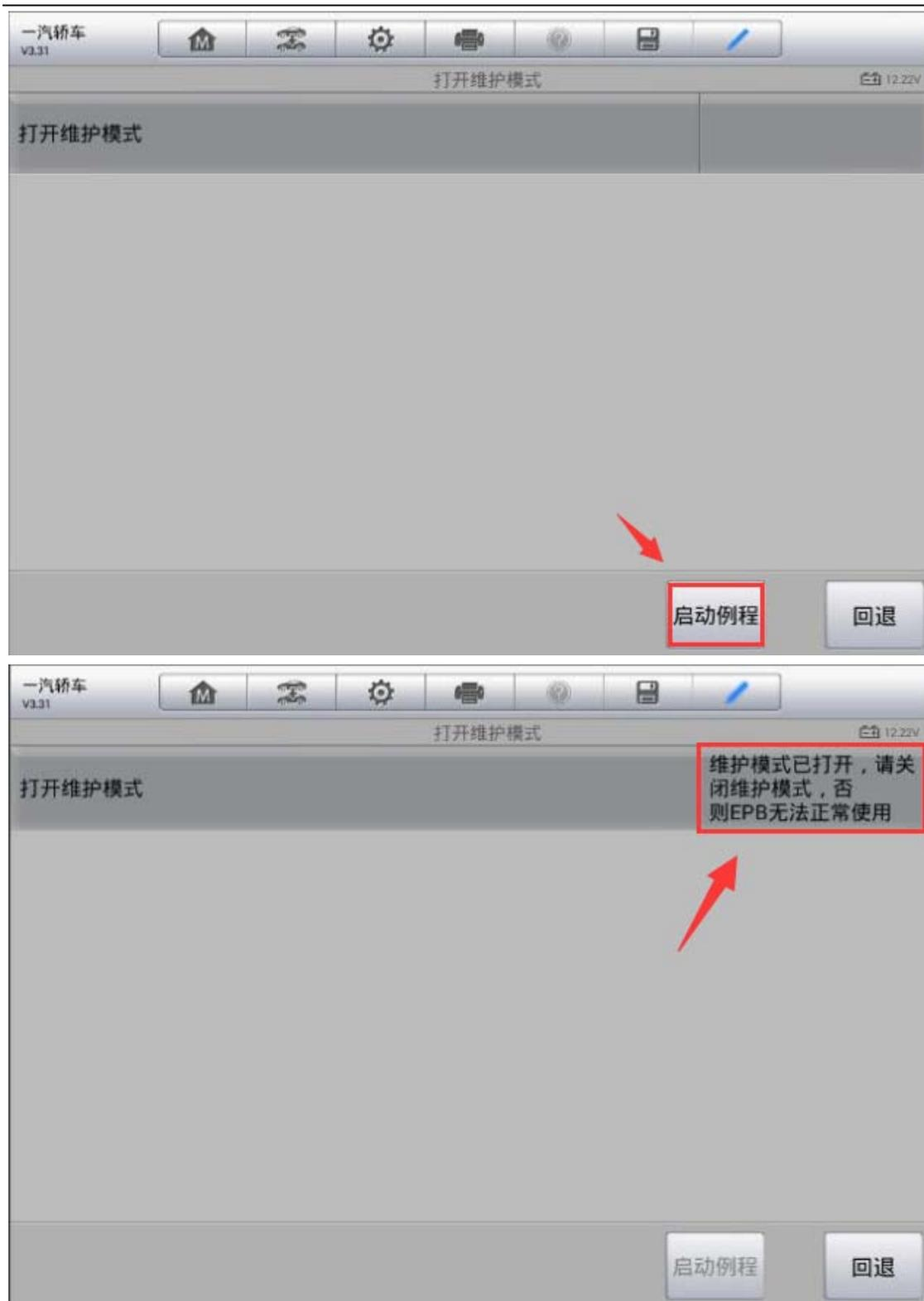
5. 更换好刹车片之后，回退，执行“关闭维护模式”功能，将维护模式关闭，为确保安全，需重新拉起手刹
