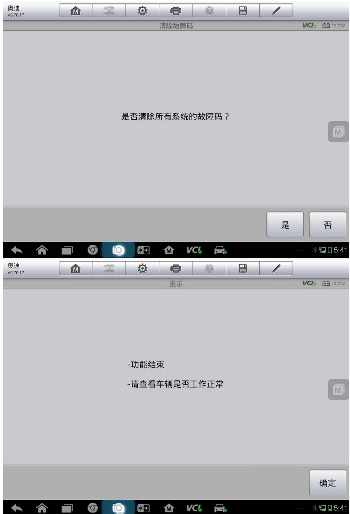
8.重新读取故障码，系统正常，方向机 ECU 在线参数化设置完成
