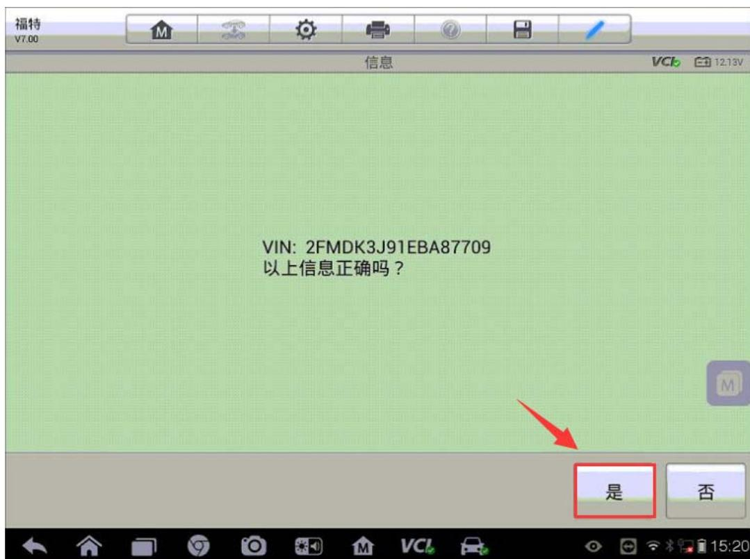
5、此时，程序已将旧模块信息读取完毕，关闭点火开关，将旧模块从车上拆下，并将新的模块装入车辆
