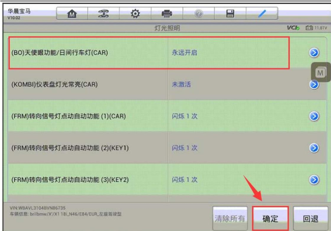
6. 点击“确定”对相应的模块进行编码，编码完成后，可以看到已开启成功的提示；开启天使眼功能完成。
