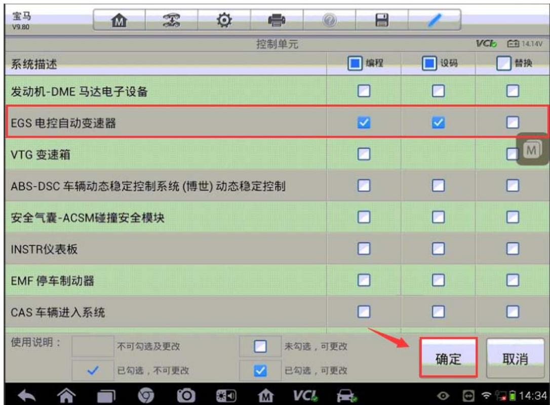
6. 此时，确保解码仪已连接网络，程序将开始在线下载编程文件；文件下载完
