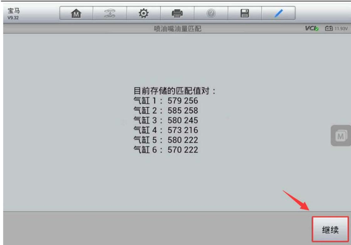
7. 执行“步骤 1 输入新的匹配值”功能，按提示依次输入 6 个新的喷油嘴的匹配值，完成后点击“确定”继续下一步。
