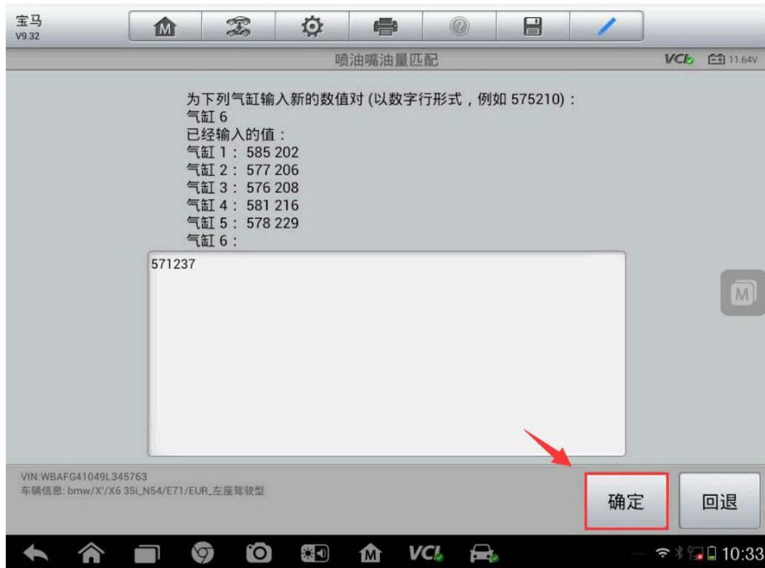
8. 输入完自后再次确定每个气缸喷油嘴的匹配值是否正确, 确认输入无误后点击“否”继续下一步。(注: 如果输入的匹配值有误, 可以点击“是”重新输入对应气缸喷油嘴的匹配值)
