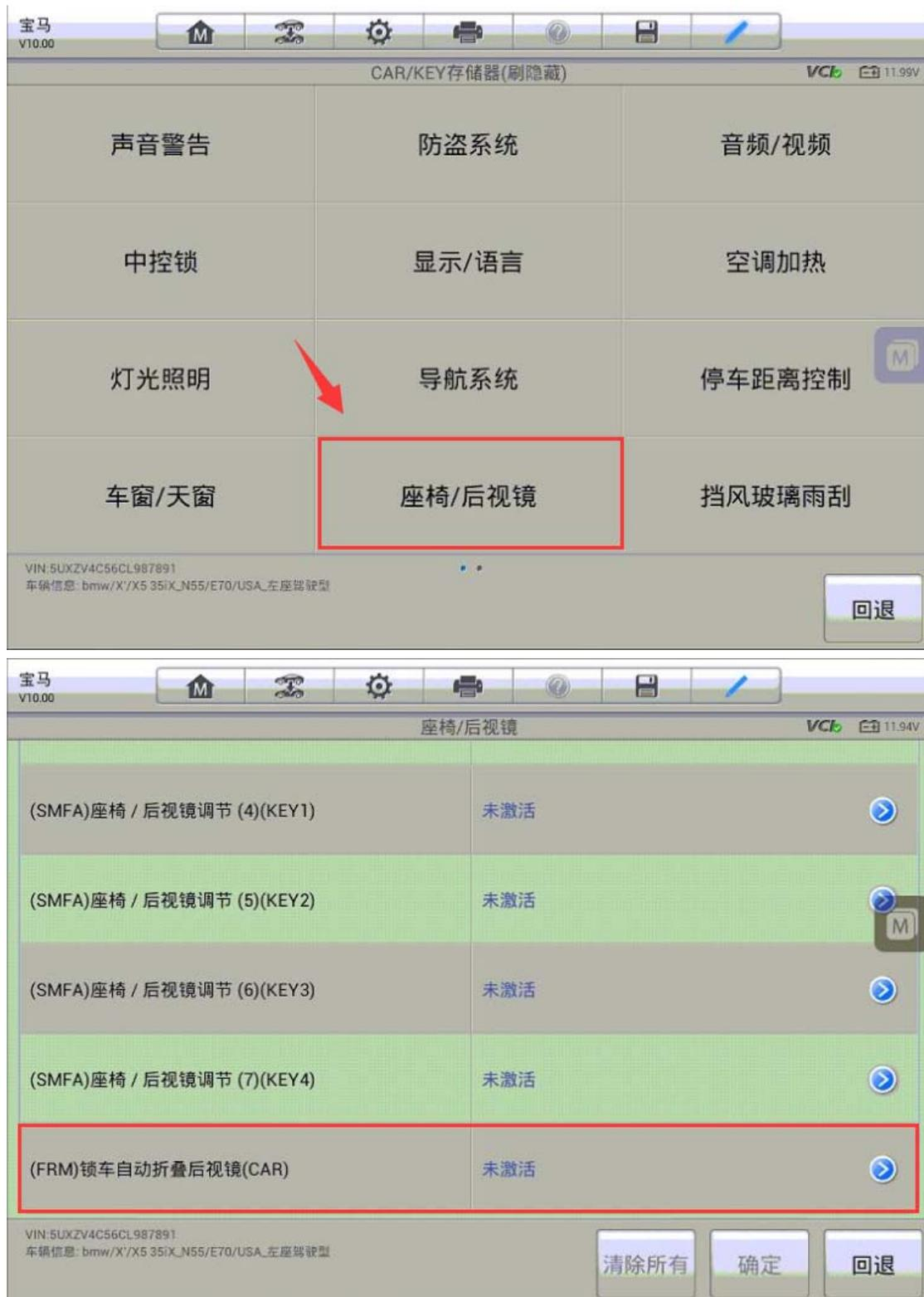
5. 进入该窗口，点击“已激活”，可以看到锁车自动折叠后视镜状态已变成“已激活” 点击“确定” 继续下一步
