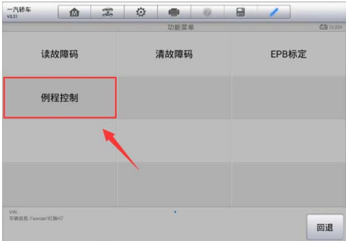
4. 执行“打开维护模式”功能，点击“启动例程”，直至维护模式显示已打开；此时刹车分泵已收回，可进行刹车片更换（注意：启动维护模式前须先释放电子手刹）
