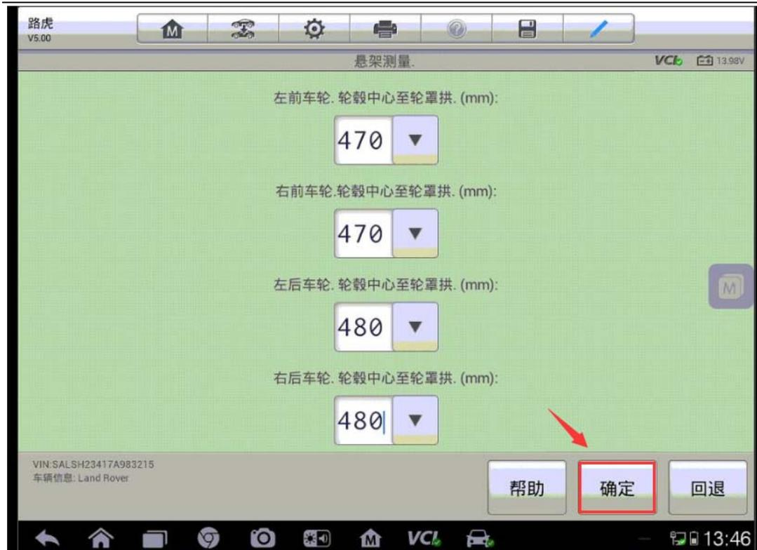
9. 此时车辆的悬挂高度控制单元会自动检测四轮高度测量值是否允许的公差范围（误差是小于或等于 3mm），如果四轮高度在允许的误差内，悬挂高度会提示标定成功；如果四轮高度超出允许的误差范围，电脑将提示四轮对应的误差值（如下图）
