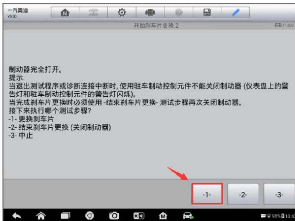
8. 按照提示进行后刹车片更换，确认新的刹车片都已正确安装，点击“确定”进入下一步
