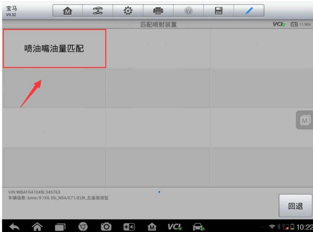
6. 该车未更换新的发动机电脑（DME），选择“否”继续下一步，可以看到当前存储的 6 个气缸喷油嘴的匹配值
