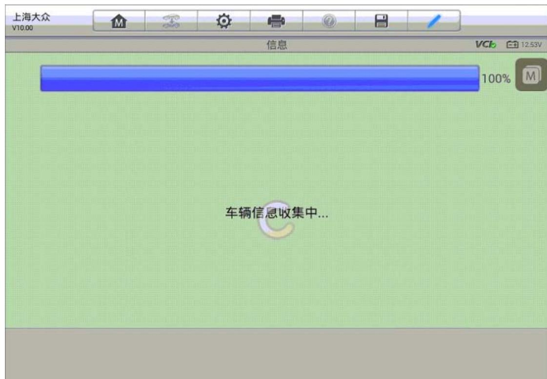
4. 车辆信息收集完成后，程序开始从服务器获取参数设置数据并对气囊系统进行参数设置；参数设置成功后按照提示清除故障码，在线参数化功能完成
