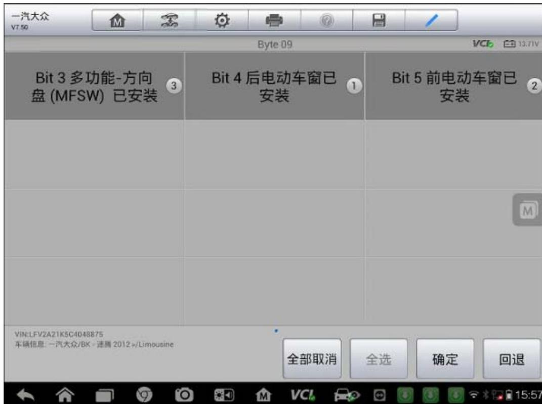
8. 在长编码界面,此时,在“字节 09”我们可以看到“Bit 3 多功能-方向盘(MFSW) 已安装”前面的状态为“√”,表明此功能已被激活,点击“确认”;
