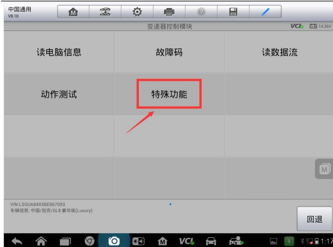
3. 阅读相关提示，并使车辆满足相应的条件；按照屏幕提示操作（注意：变速器吹洗过程中，如果持续时间过长，请轻踩油门，将发动机转速提高到 1500 转/分以上）
