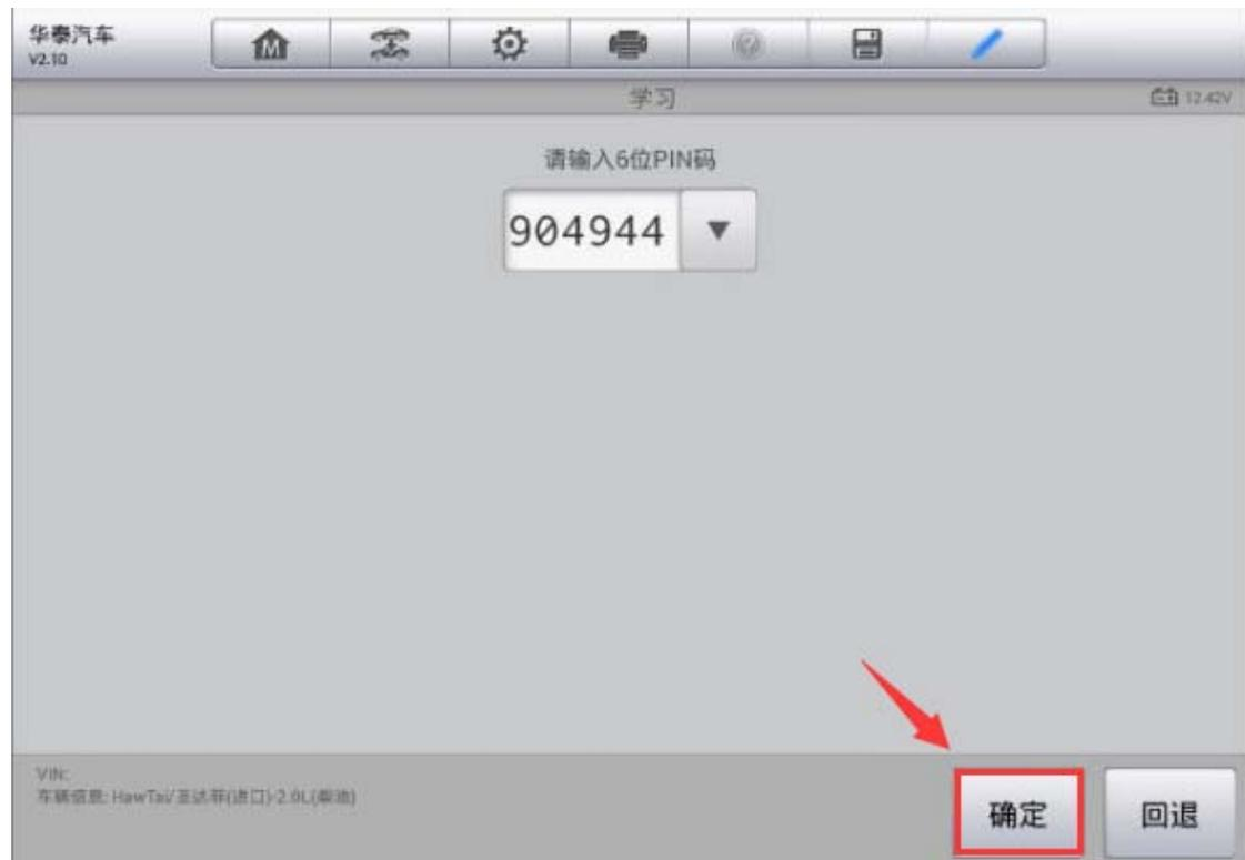
5. 将需要匹配的第一把钥匙插入钥匙孔，并打开点火开关，点击“确定”继续下一步，程序提示完成，第一把钥匙匹配完成；如果需要匹配多把钥匙，继续按提示操作，直至所有钥匙匹配完成
