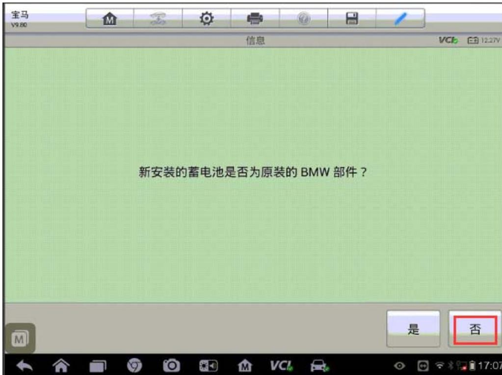
9. 蓄电池更换已经成功记录（注意：为了记录新的蓄电池的电容量或蓄电池类型，需进入编程功能里面的“加装/改装”功能按提示执行加装功能）
