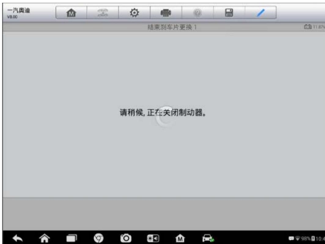
10. 确认制动器已完全关闭后，安装轮胎，检查制动液液位，必要时进行添加，完成后继续下一步，结束刹车片更换功能。
