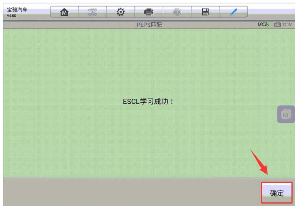
6. 按照提示打开点火开关，ECM 学习 ESK 成功，转向柱锁匹配完成。
