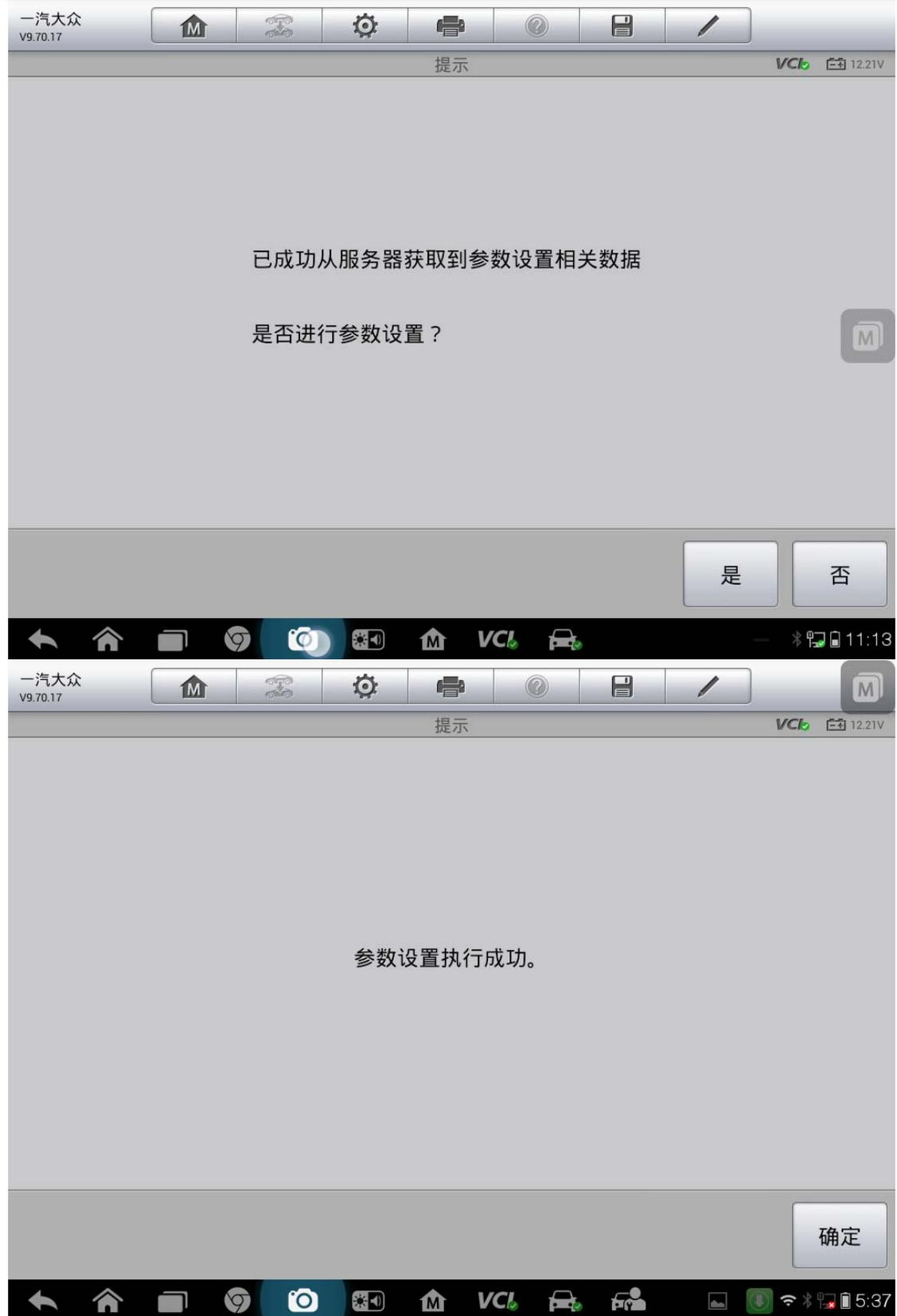
6.关闭点火开关，等待大约 30S 左右，再打开点火开关
