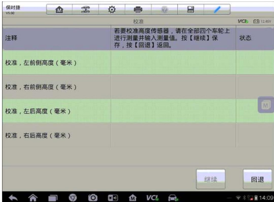
8. 示测量四轮高度值，并输入相应位置（注：测量高度方法为轮胎的最高点到轮眉的垂直高度，一般前轮与后轮高度分别是一致的，单位为 mm），点击“继续”
