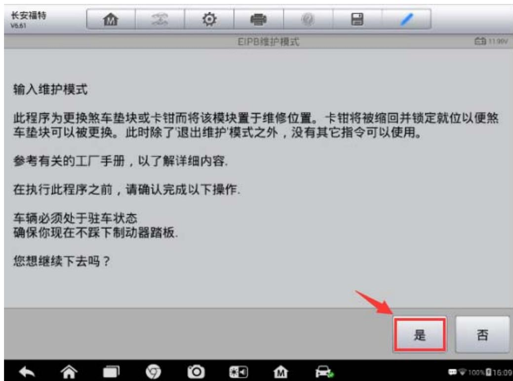
5. 此时，刹车卡钳已被缩回并锁定，按要求更换新的制动片，更换完毕后点击“确定”进入下一步
