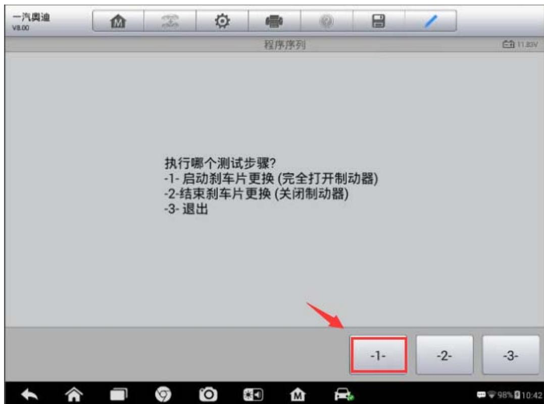
6. 接下来制动器完全打开，点击“确定”，可以听到刹车分泵电机工作的声音，制动器会被完全打开
