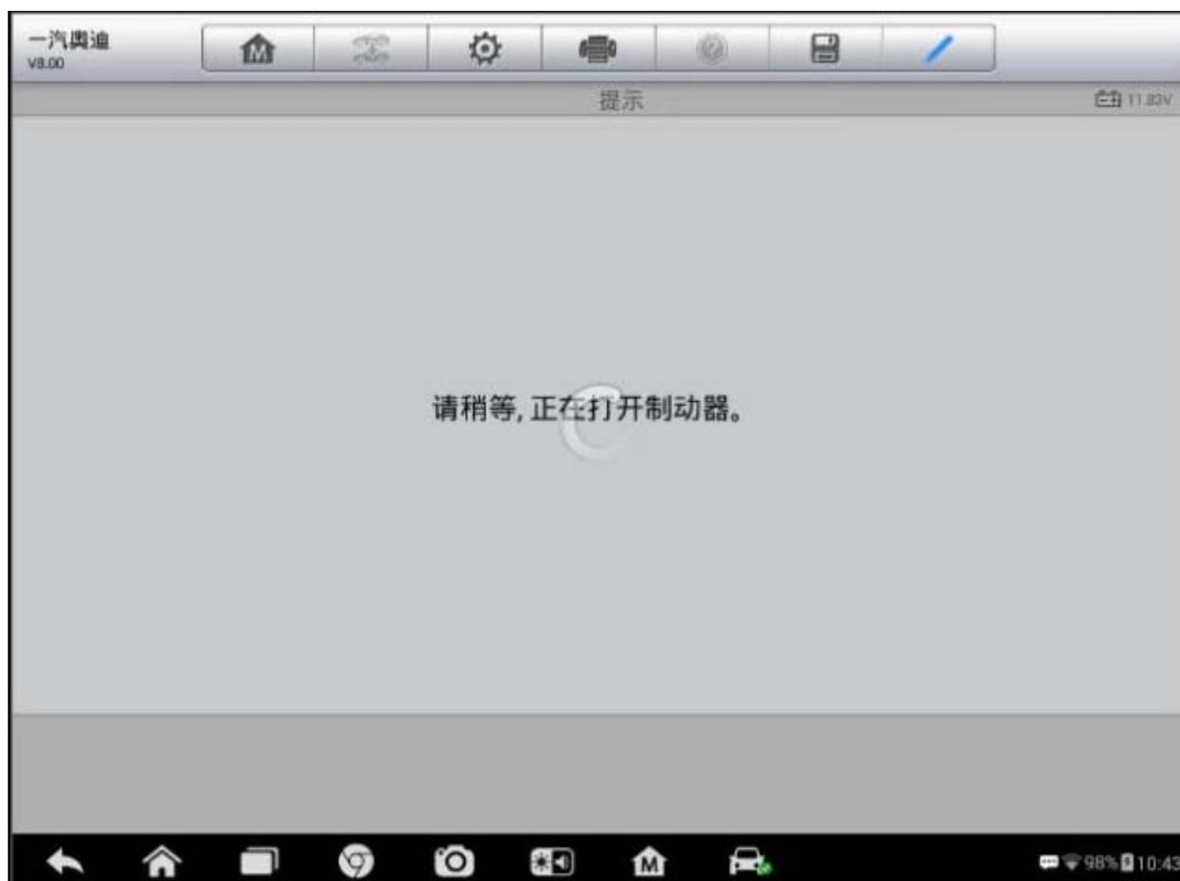
7. 确认制动器已被完全打开，活塞已收回至刹车片更换位置后，执行“1-更换刹车片”（注：当退出测试程序或诊断连接中断时，使用驻车制动控制元件不能关闭制动器，此时仪表上的警告灯和驻车控制元件的警告灯会闪烁；当完成刹车片更换时必须执行“2-结束刹车片更换（关闭制动器）”功能再次关闭制动器）
