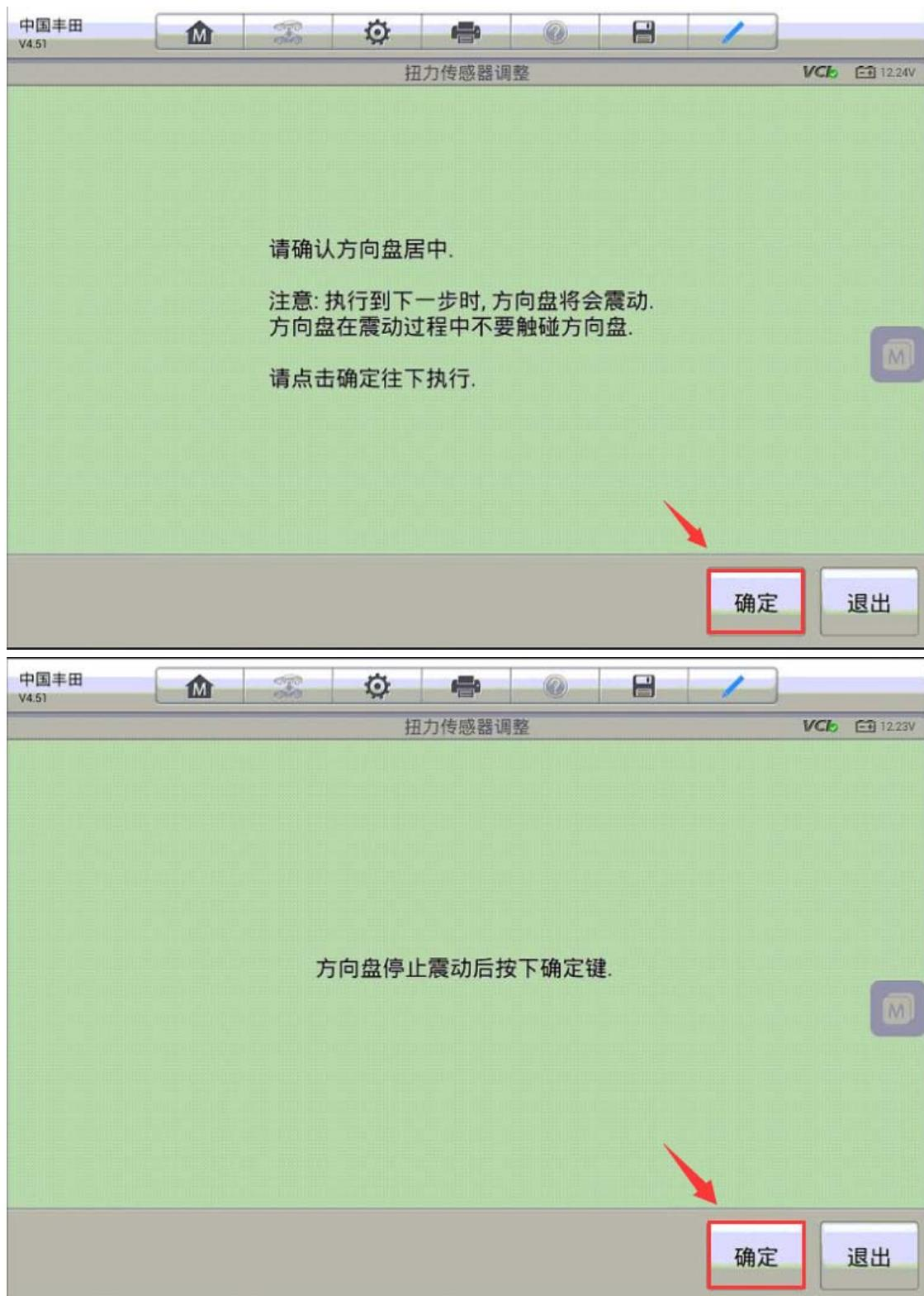
8. 方向盘震动完成后程序将开始标定，直至提示扭矩传感器调整完成。
