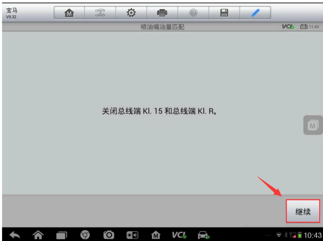
10. 新的喷油嘴的匹配值已储存，接通点火开关点，点击“继续”完成（注：由于控制单元换算，数值的最后一位可能与喷油嘴数值有轻微偏差，该偏差不是故障。）
