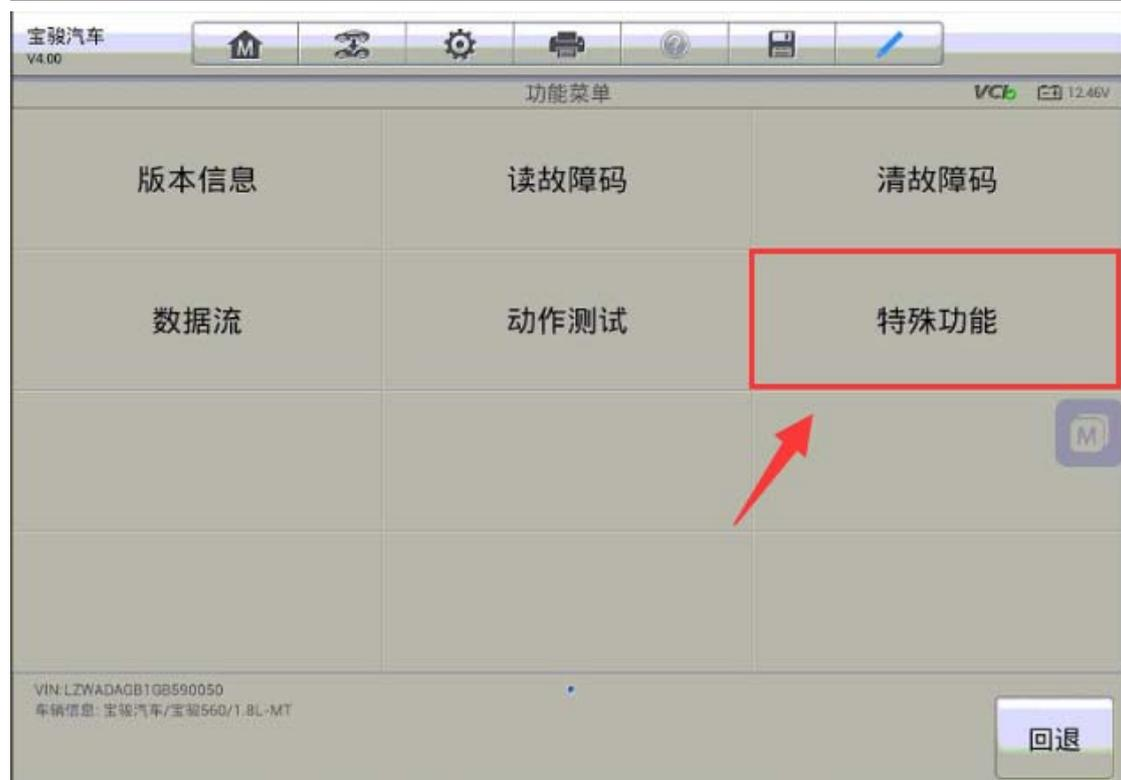
3. 执行“DCU 在线配置”功能，该功能需要在线连接服务器进行匹配，请连接有效网络再进行匹配
