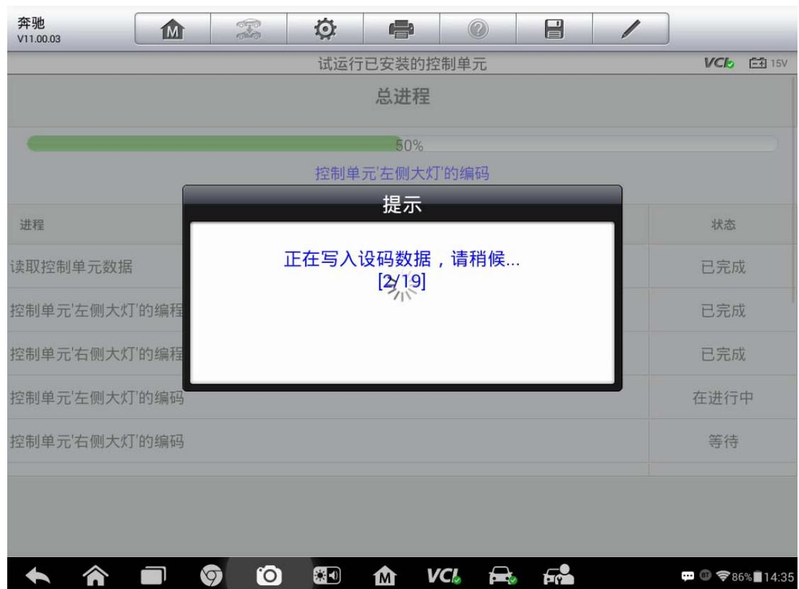
7. 设码完成后程序自动进入控制单元学习功能，执行大灯调校设码功能；使用手持式扫描仪扫面大灯模块上的“LED CODE”以及“BB”二维码，然后按要求依次输入“LED CODE”以及“BB”二维码的码号，点击“继续”按钮（**注意：“LED CODE”以及“BB”二维码在大灯模块上**）
