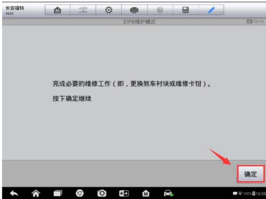
6. 再次检查新更换的制动片都安装正确，点击“确定”退出维护模式，制动片更换工作完成。
