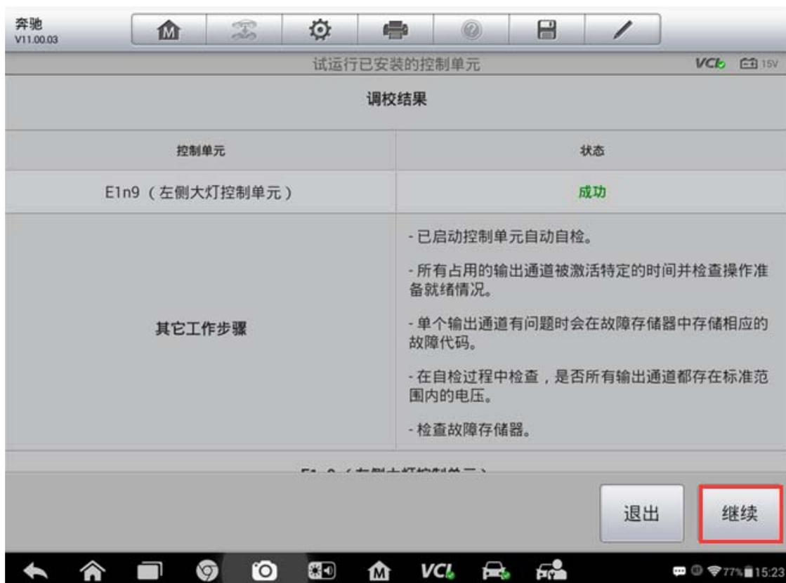
8. 至此，大灯模块的编程已经完成，故障灯熄灭，大灯功能正常，故障排除。
