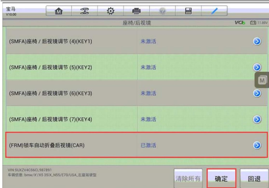
6. 点击“确定”对相应的模块进行编码，编码完成后，可以看到已激活成功的提示；使用遥控器锁车后视镜可自动折叠，功能完成。
