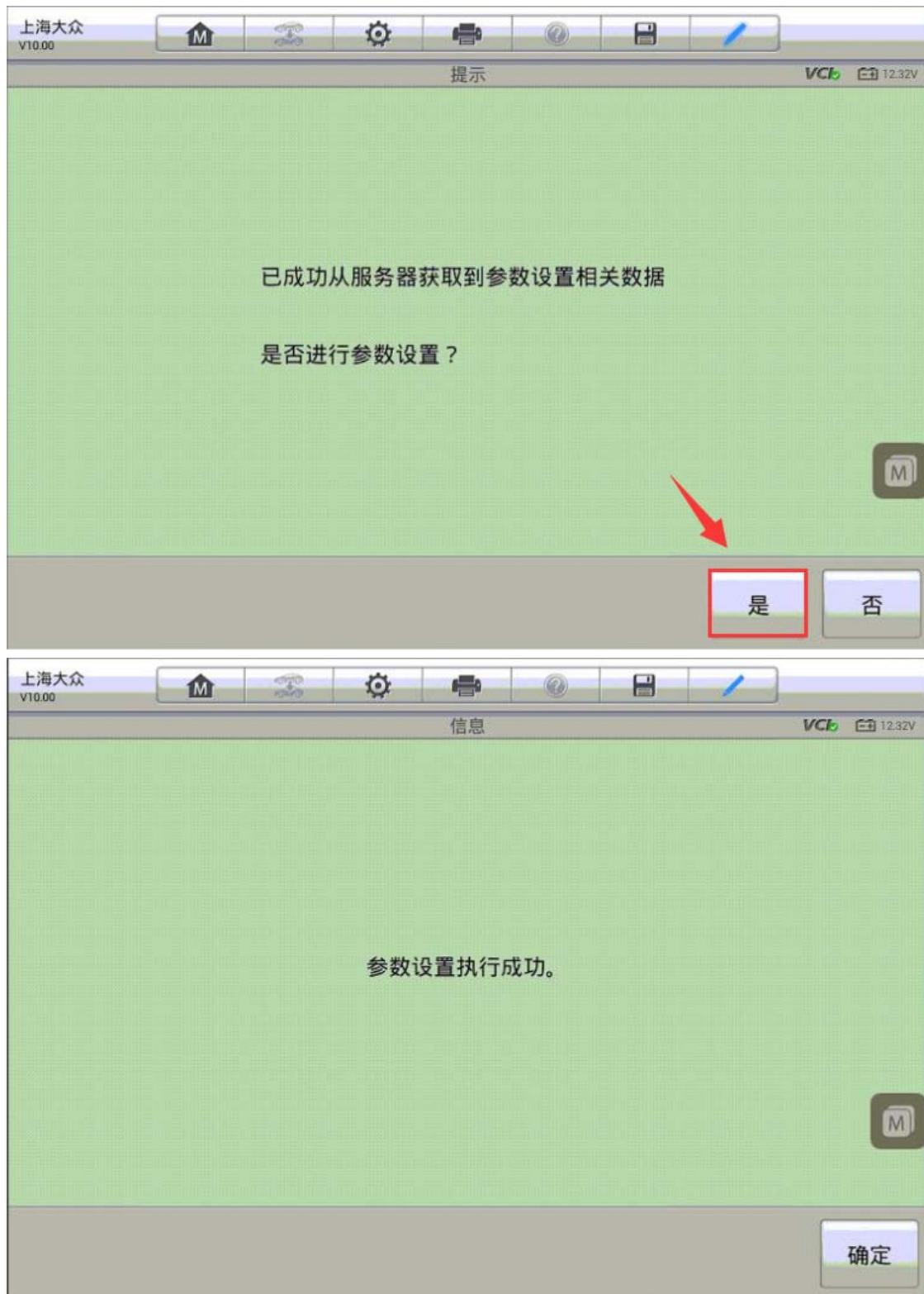
6. 编码写入成功，可以看到当前编码已和建议编码值一致，再次检测系统提示无故障码，仪表气囊故障灯熄灭，问题成功解决。
