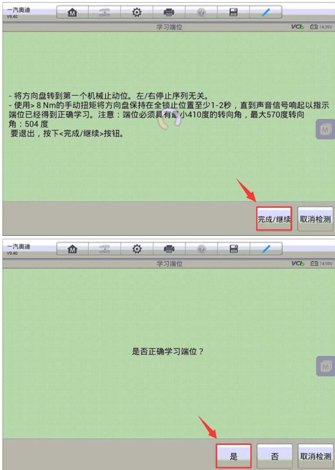
8. 将方向盘转到另一个机械止动位，确保端位正确学习后点击“是”继续下一步
