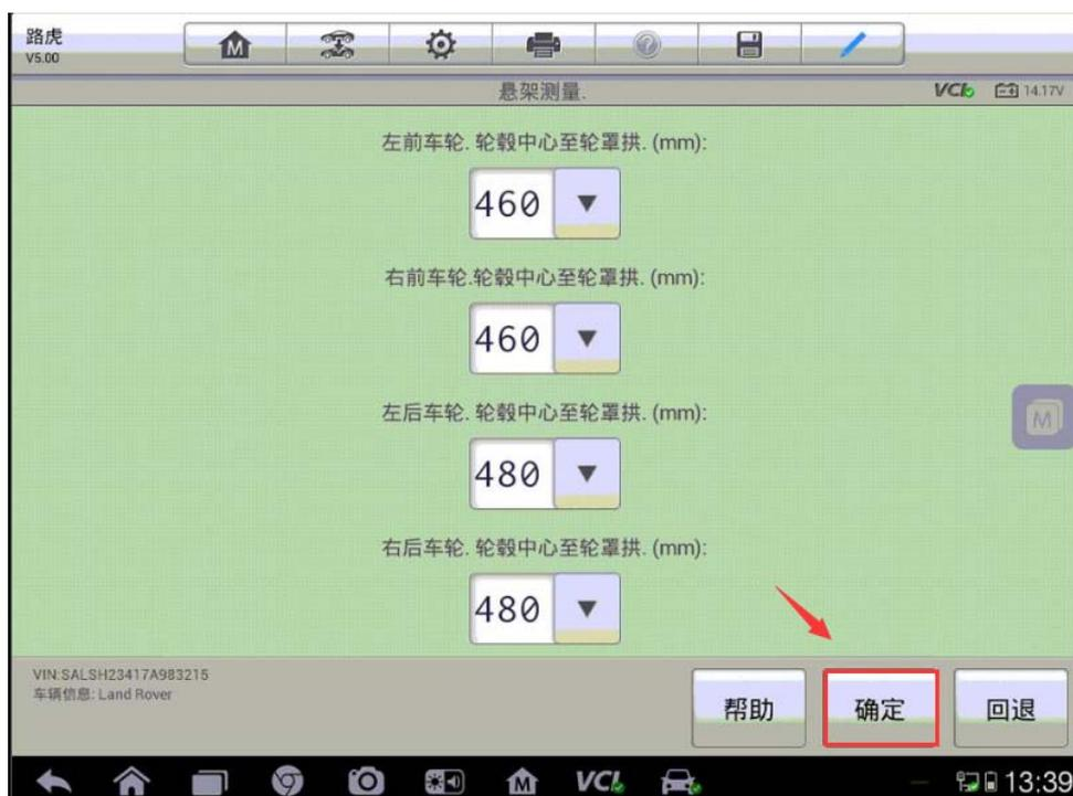
8. 车辆悬挂将转入越野行驶高度，再转入正常行驶高度，之后需再次输入四轮悬架测量值，确保测量值都在允许误差范围内后继续下一步
