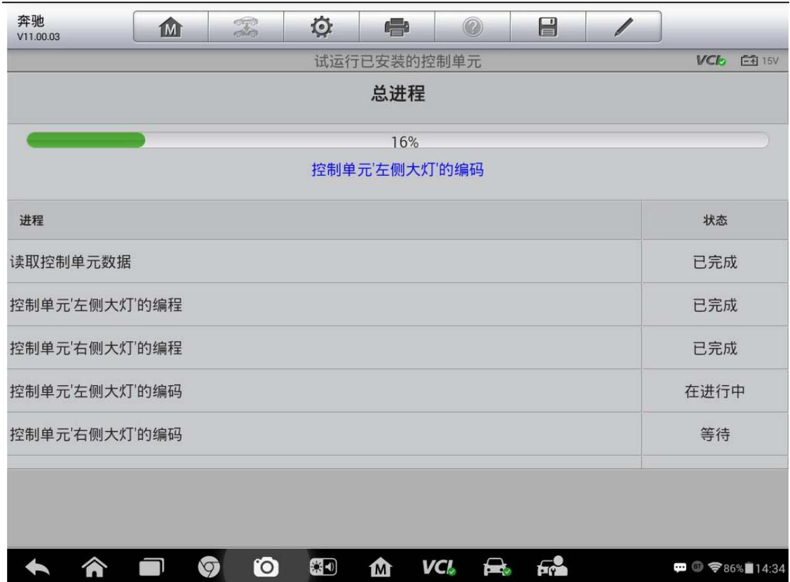
6. 编程完成后，开始执行模块设码，程序会从服务器获取设码数据并开始写入设码数据
