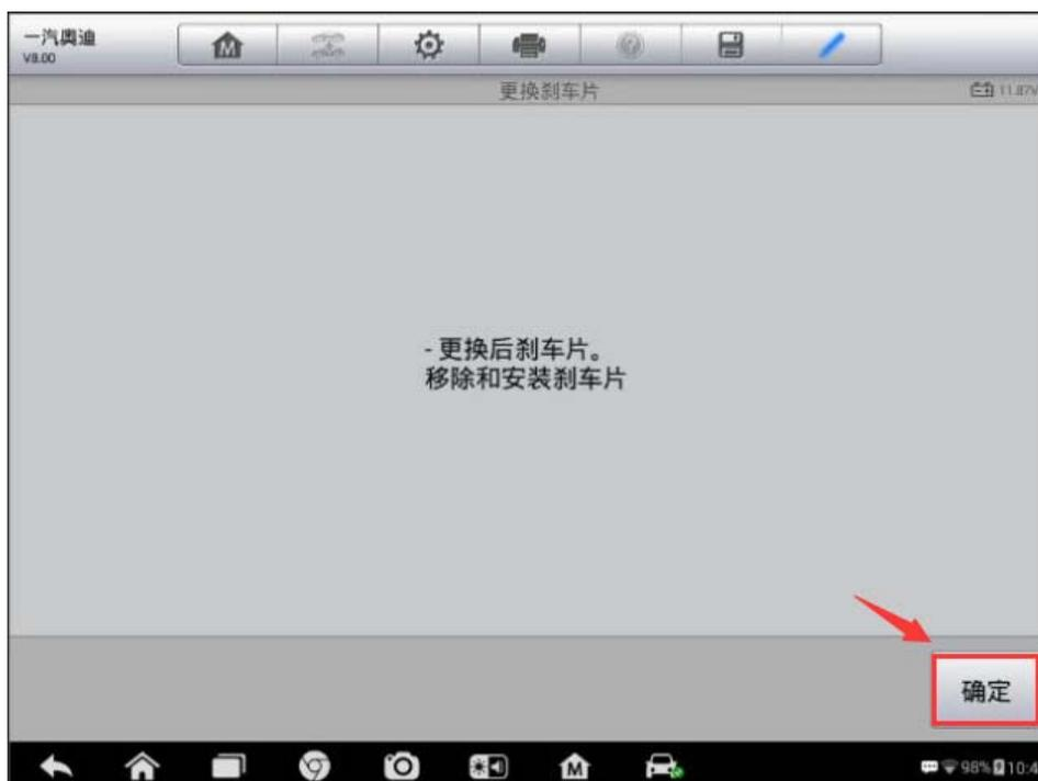
9. 接下来关闭制动器，点击“确定”，制动器会关闭，制动活塞回到工作位置
