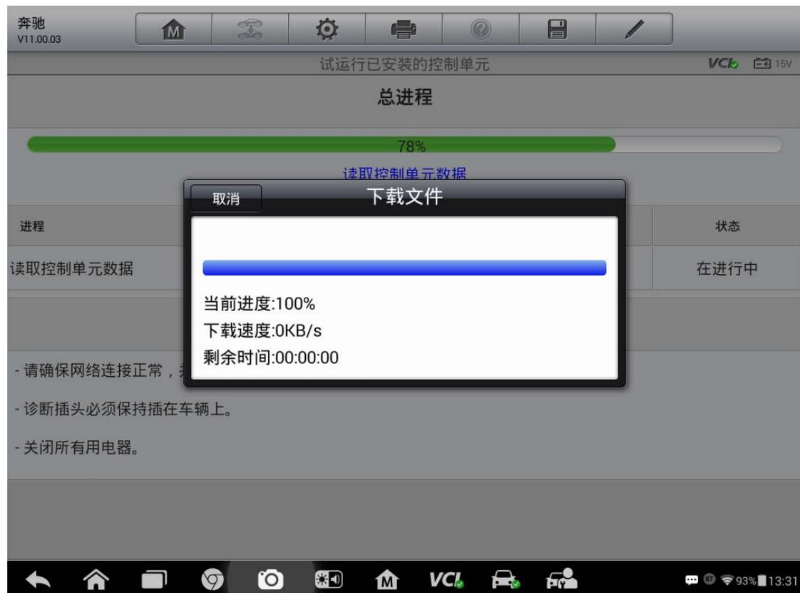
4. 编程文件下载完成后，可以查看到控制单元当前的软件版本以及从服务器获取的新版本，点击“是”开始编程（**注意：程序将会提示是否对关联系统进行编程，为了确保车辆相关系统正常，建议点击“是”，程序将会下载相关系统的编程文件，此处的相关系统是右侧大灯**）
