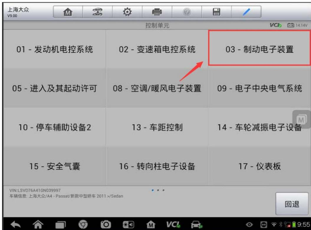
4. 此时，程序将会从服务器获取控制单元的数据，请确保网络稳定，并使用 USB 线连接 VCI，按提示继续下一步（注：连接服务器获取新模块数据需要花费一定时间，请耐心等待）
